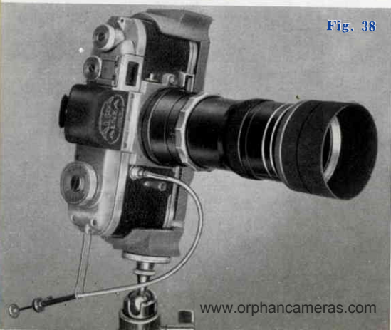
Fig. 38. Kamera mit Usan auf Stativ für Vertikalaufnahmen.
